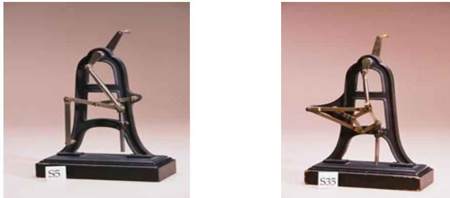
Εικόνα 21 : Ευθυγράφοι Watt και Peaucellier, από συλλογή Reauleaux στο Cornell University
