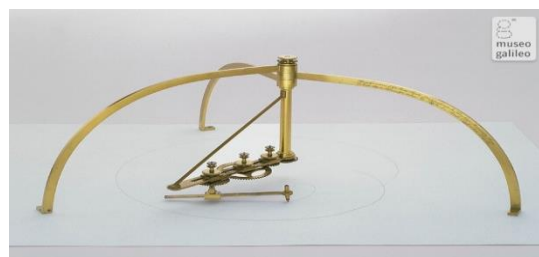
Εικόνα 11 : Μαθηματικές μηχανές του Suardi (α) χάραξης κογχοειδούς καμπύλης του Νικομήδη (drawingmachines.org) και χάραξης μεγάλης ποικιλίας καμπυλών (κατάλογος από Μουσείο Galileo).
