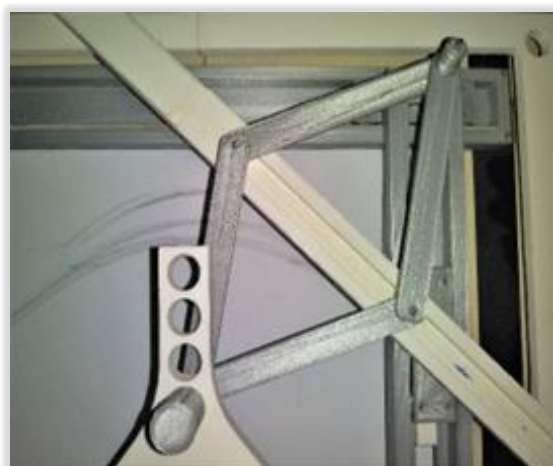
Εικόνα 56 : Ο πρώτος παραβολογράφος van Schooten μέσω τρισδιάστατης εκτύπωσης
