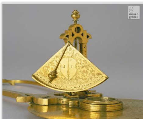
Εικόνα 10 : Θεοδόλιχος αζιμουθίου του Baldassarre Lanci (1557) & διαβήτη μείωσης (αγνώστου κατασκευαστή) με κινούμενο κέντρο για μείωση των μετρήσεων κατά συντελεστή. Μουσείο Galileo στη Φλωρεντία.
