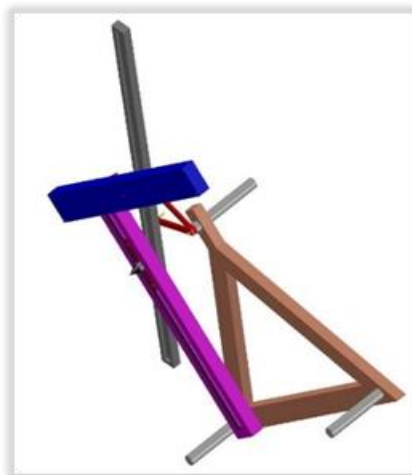
Εικόνα 55 : Σχεδιασμός πρώτου παραβολογράφου van Schooten (autoCAD)
