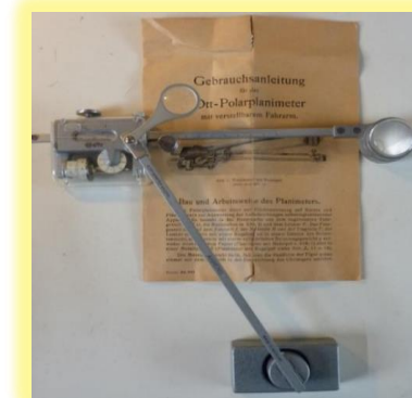
Εικόνα 23 : «Πολικό εμβαδόμετρο του Amsler από το βιβλίο του Horsburgh, M. (1914)» & «Πολικό εμβαδόμετρο, τύπος 31, αρ.89475, παραγωγή A. Ott, Kempten, Βαυαρία»
