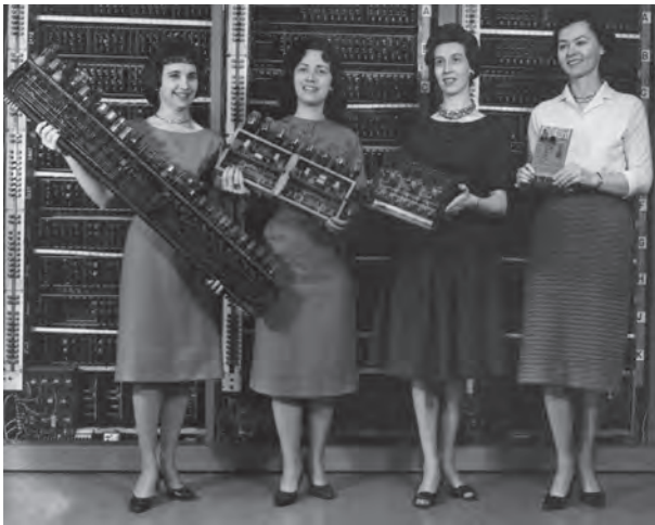
Εικόνα 4.3. Διάφορες πλακέτες υπολογιστών. Μέσα σε δύο δεκαετίες το μέγεθος μικραίνει εντυπωσιακά. (Από τα αριστερά): ENIAC, ED-VAC (ηλεκτρονικές λυχνίες), ORDVAC (τρανζίστορ), BRLESC-I (1962, ολοκληρωμένα κυκλώματα)
