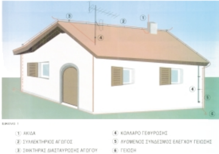
Σχήμα 6.6.4: Τυπικό σύστημα εξωτερικής αντικεραυνικής προστασίας οικίας
