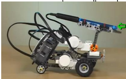
Σχήμα 1: Το ρομπότ μετά την συναρμολόγησή του έτοιμο για μέτρηση pH.
