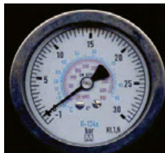
Σχήμα 6.1.2: Μανόμετρα (υψηλής, χαμηλής) για συστήματα κλιματισμού αυτοκινήτων.
