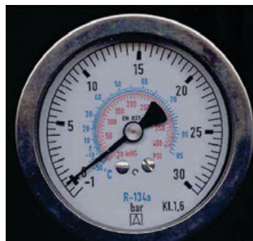
Σχήμα 6.1.3: Μανόμετρο και με ένδειξη θερμοκρασίας.
