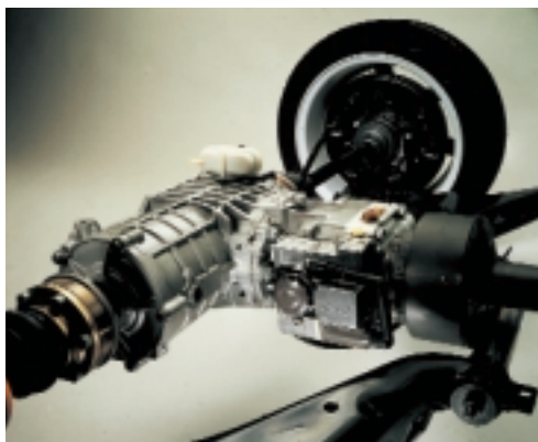
Σχήμα 1.88: Πίσω άξονας με σύστημα HALDEX.
