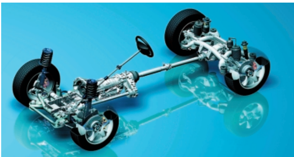
Σχήμα 1.72: Το σύστημα μετάδοσης ενός τετρακίνητου οχήματος.
