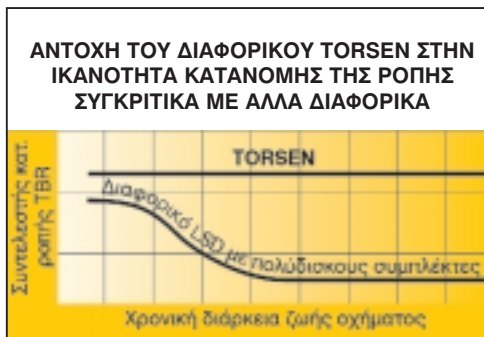
Σχήμα 1.69: Αντοχή του διαφορικού Torsen σε σχέση με άλλα LSD διαφορικά.
