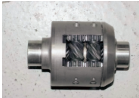
Σχήμα 1.75: Κεντρικό διαφορικό τύπου Τόρσεν.
