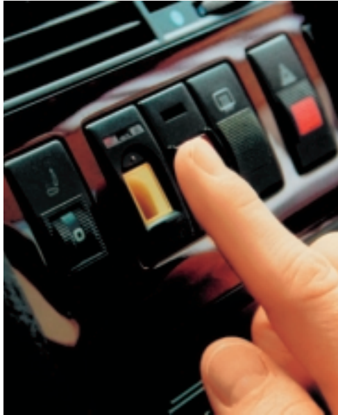
Σχήμα 8.3: Αναγνώριση του οδηγού μέσω του δακτυλικού αποτυπώματος.
