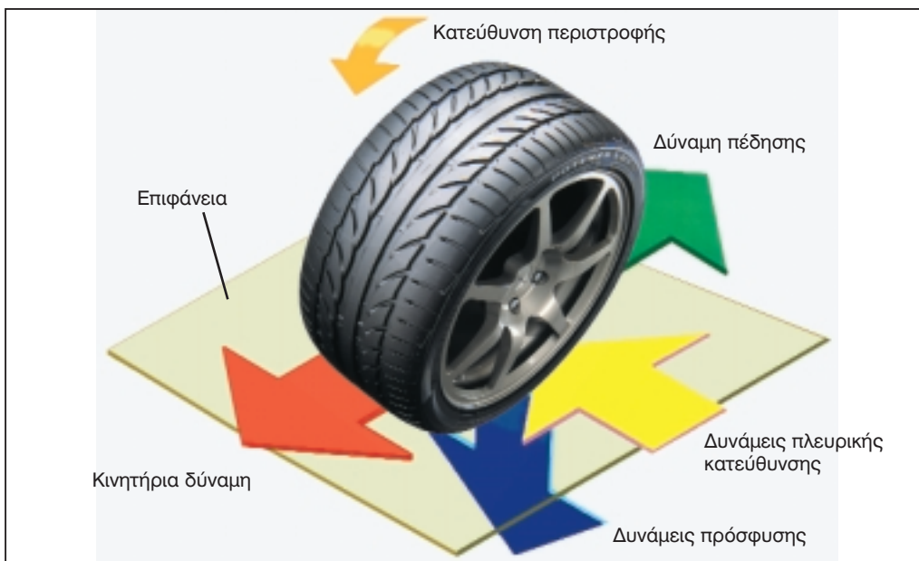
Σχήμα: 4.2: Δυνάμεις που επενεργούν στον τροχό του αυτοκινήτου.
