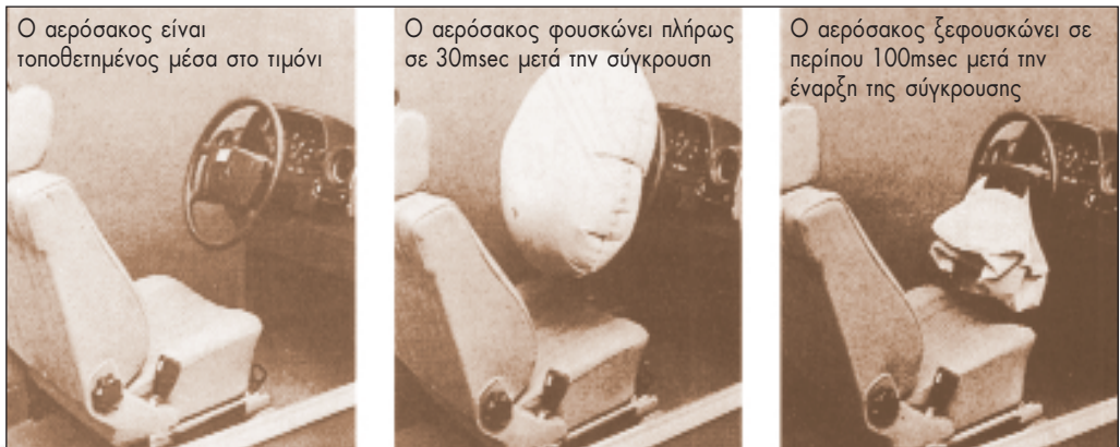
Σχ.9.7 Αερόσακος προστασίας από μετωπική σύγκρουση.
