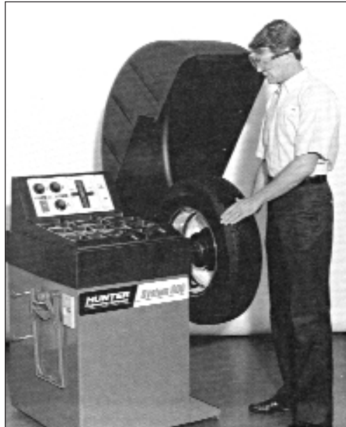
Σχ.5.63 Σύγχρονο μηχανήμα ζυγοστάθμισης, το οποίο δείχνει που και πόσο βάρος είναι αναγκαίο να προστεθεί, για να διορθωθεί η ζυγοστάθμιση του τροχού.
