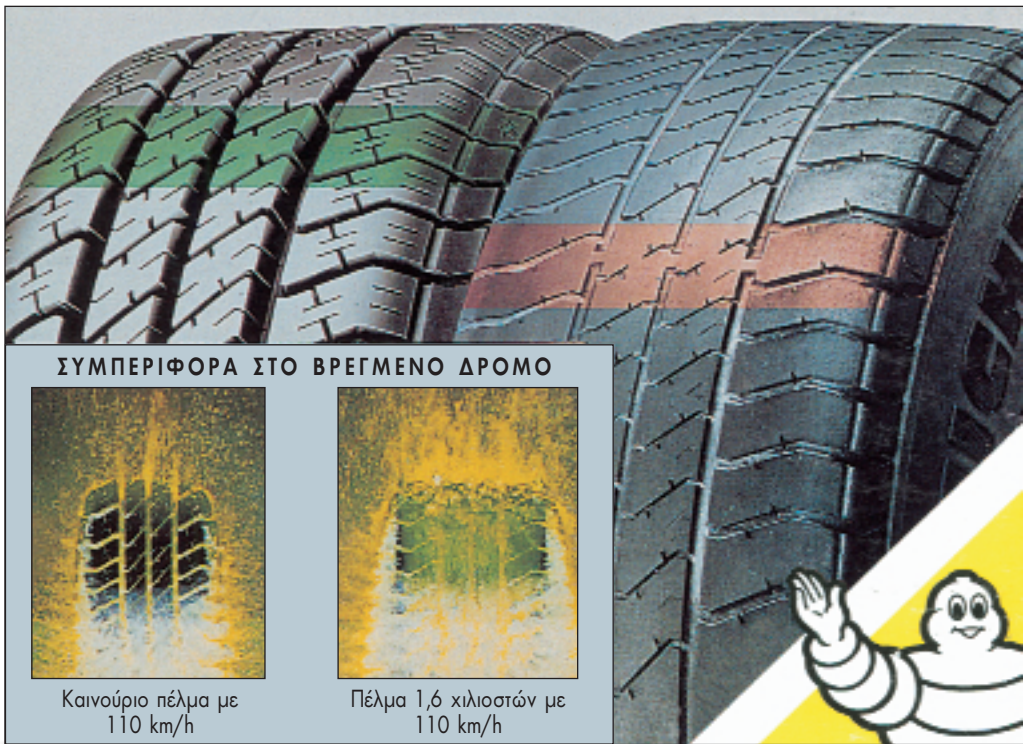
Σχ.5.51 Συμπεριφορά καινούργιου και φθαρμένου ελαστικού σε βρεγμένο δρόμο.
