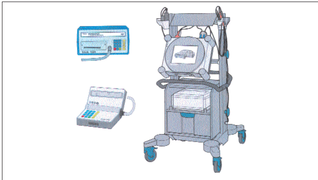
Εικόνα 5.14 Ειδικά τέστερ και εγκέφαλος αυτοδιάγνωσης βλαβών
