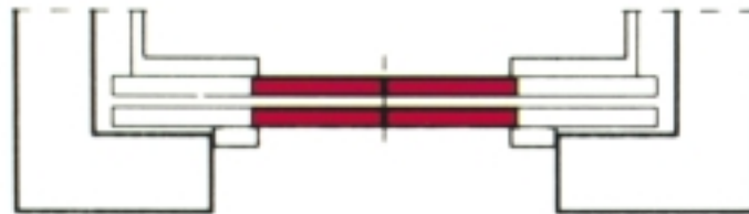
Σχέδιο 3.8 Αυτόματες θύρες κεντρικού ανοίγματος
