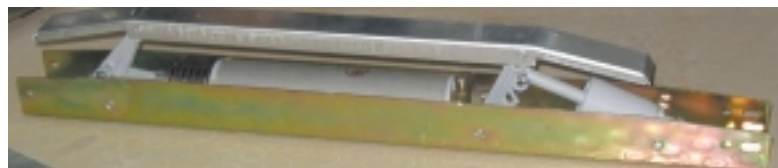
Σχέδιο 3.13 Μηχανισμός απομανδάλωσης ανοιγόμενης θύρας ανελκυστήρα
