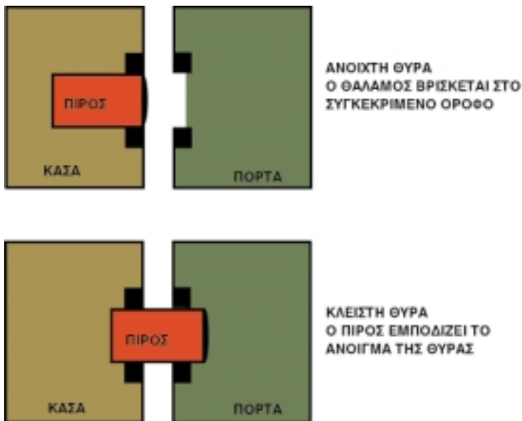
Σχέδιο 3.12 Κλείδωμα ανοιγόμενης θύρας ανελκυστήρα
