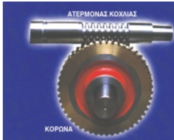
Σχέδιο 2.12 Ατέρμονας κοχλίας με κορώνα
