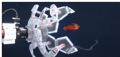
Εικόνα 17: Το δοχείο που χρησιμοποιείται για να συλλέγει μαλακά θαλάσσια ζώα. Πηγή: Ινστιτούτο Wyss
