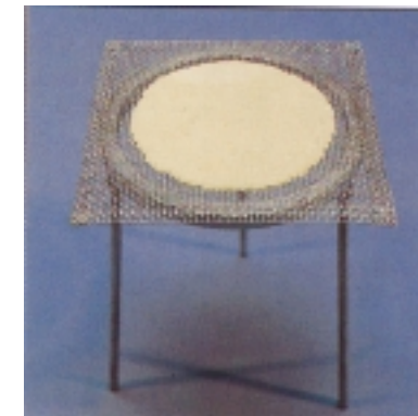
A5 Μεταλλικό τρίποδο με πλέγμα αμιάντου
