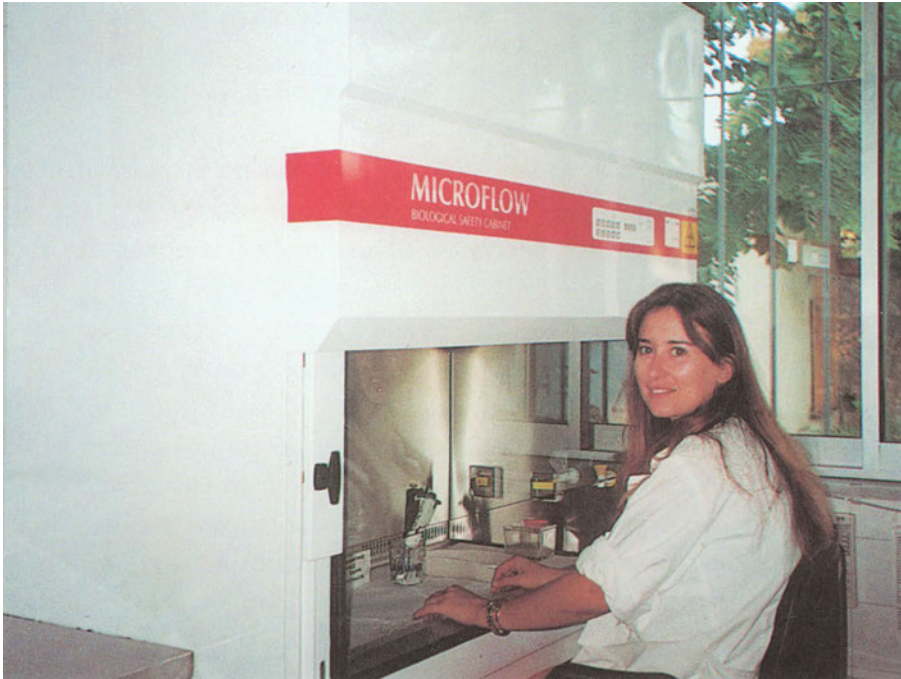
Εικόνα 10.1: Καμπίνα βιολογικής ασφάλειας
