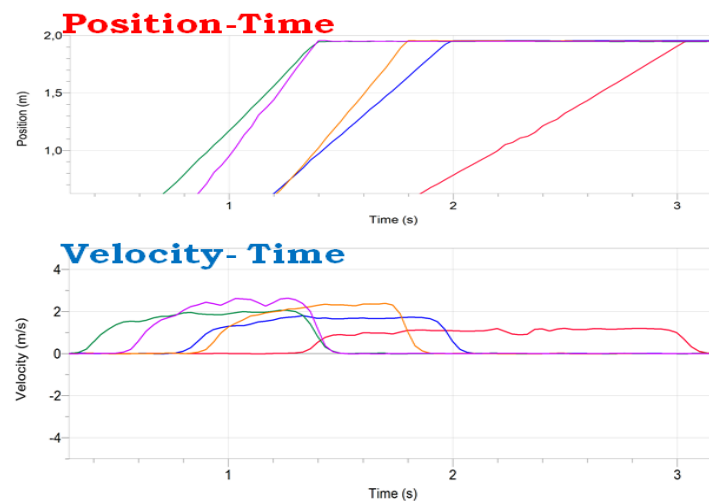
Σχήμα 6. Διαγράμματα θέσης-χρόνου και ταχύτητας-χρόνου για διάφορες μάζες σωμάτων
