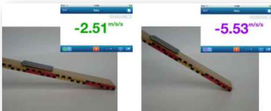
Εικόνα 3. Η καταγραφή της επιτάχυνσης ενός ολισθαίνοντος smartphone σε κεκλιμένα επίπεδα με διαφορετική κλίση (Vogt & Kuhn, 2014a)
