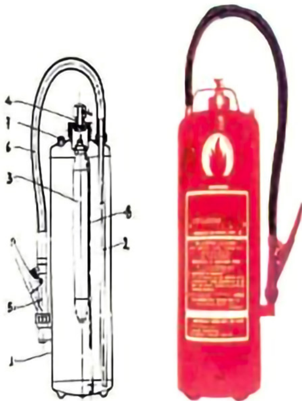
Πυροσβεστήρας ξηράς σκόνης με εσωτερικό φιαλίδιο
