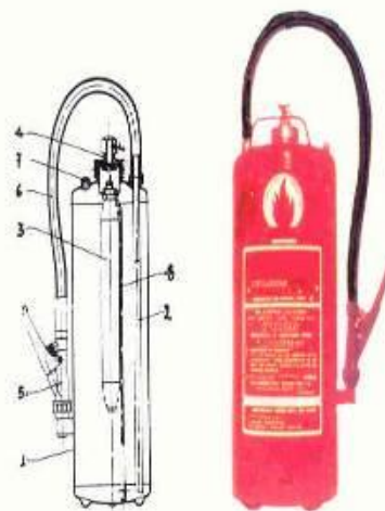
Πυροσβεστήρες ξηράς σκόνης με εσωτερικό φιαλίδιο
