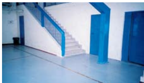
Ακατάλληλη χωροταξία κλειστού γυμναστηρίου: σκάλα-κάγκελα πολύ κοντά στα όρια του γηπέδου (μικρό περιθώριο διαφυγής παικτών) και έλλειψη κατάλληλου μαλακού υλικού γύρω από την στήριξη της μπασκέτας (Θεσσαλονίκη 2005).
