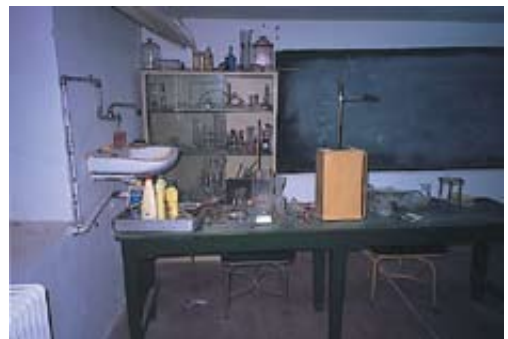
Μη αποδεκτή εικόνα εργαστηρίου. Λείπουν παντελώς προστατευτικά μέσα (γυαλιά, γάντια, προστασία προσώπου, ντους νερού για μάτια, προστατευτικές διαφανείς ασπίδες κλπ.) (Θεσσαλονίκη 2005).
