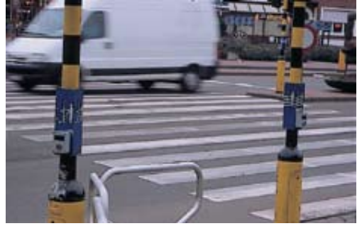
Διακόπτης με ηχητική ειδοποίηση για τυφλούς σε διάβαση πεζών στην Ολλανδία. Τοποθετήθηκαν σε ορισμένες διαβάσεις και στην Ελλάδα αλλά καταστράφηκαν και αφαιρέθηκαν! Επικίνδυνο για τυφλούς να βασίζονται σε ηχητικό σήμα στην Ελλάδα (αν υπάρχει!): Τουλάχιστον 3 οχήματα παραβιάζουν τον σηματοδότη.
