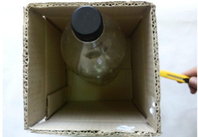
Με το κοπίδι (ή με το ψαλίδι) ανοίγουμε στο χάρτινο κουτί, στην κορυφή και στο κάτω μέρος, δυο κυκλικές οπές με μέγεθος ανάλογο της διαμέτρου του λάστιχου μας και στο ύψος των οπών που ανοίξαμε στο πλαστικό μπουκάλι.
