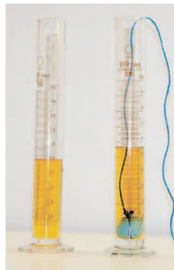
Εικόνα 1 Πειραματική διάταξη για τη μέτρηση του όγκου στερεού σώματος
