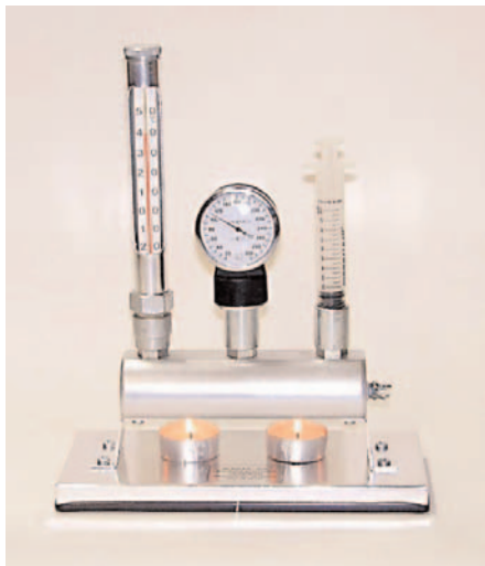
Εικόνα 3 Συσκευή μελέτης των νόμων των αερίων
