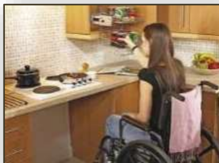
Εικόνα 167. Επίπλωση χώρου κουζίνας (πάγκοι, ντουλάπια) κατάλληλη για χρήση αναπηρικού αμαξιδίου (Δημουλά, κ.ά., 2023)
