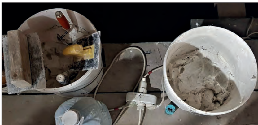
Τα υλικά για την «όψη» του φρέσκο, ασβέστης με λινάρι, μυστριά και τριβίδια.
