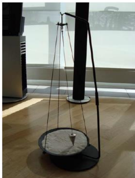
Εικ 2. Το μικρό εκκρεμές που χρησιμοποιήθηκε για τον έλεγχο σχετικά με την επίδραση της περιστροφής το σημείου εξάρτησης στο επίπεδο ταλάντωσης του εκκρεμούς.
