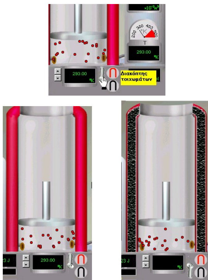
Εικόνα 6.8: Τοιχώματα σταθερής θερμοκρασίας (αριστερά) και αδιαβατικά τοιχώματα (δεξιά)
