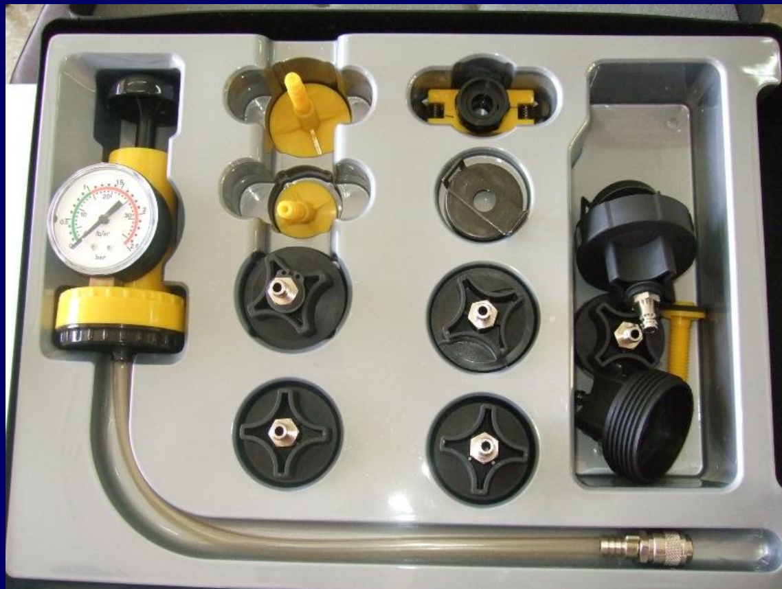
Συσκευή ελέγχου πίεσης νερού ψυγείου
