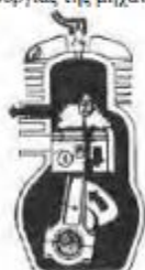
Σχ. 6/13: Καταπόνηση διστήρα μηχανής εσωτερικής καύσης σε λυγισμό.
