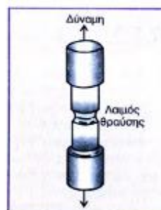
Σχ. 6/21: Σχηματισμός λαμμού θραύσης και διαρροής
