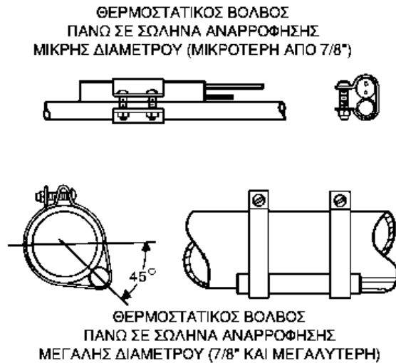
Εικόνα 5.12: Εγκατάσταση του Θερμοστατικού Βολβού πάνω στη σωλήνα αναρρό- φησης
