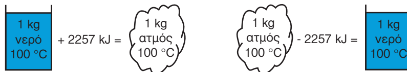
Εικόνα 1.26: Σε κανονική ατμ. πίεση η λανθάνουσα θερμότητα εξάτμισης και συμπύκνωσης για το νερό είναι ίσες ( 2257 \text{ kJ/kg} \approx 539 \text{ kcal/kg} ). Η αντίστοιχη θερμοκρασία κορεσμού είναι 100^\circ\text{C}
