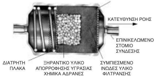
Εικόνα 7-3B: Εξωτερική όψη και τομή φίλτρου – Ξηραντή γραμμής υγρού
