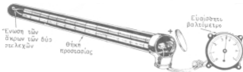
Σχήμα 6.3.2: Βιομηχανικό θερμόμετρο με θερμοστοιχείο
