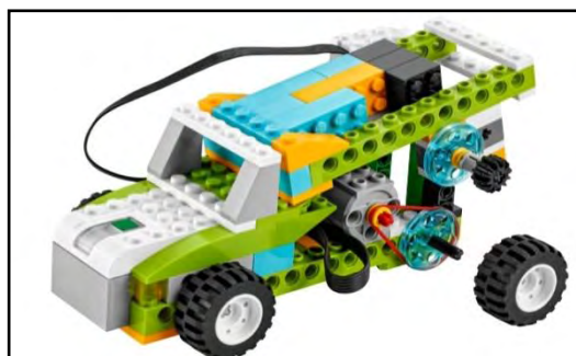
Εικόνα 20. Σύνδεση του κινητήρα με τους τροχούς
