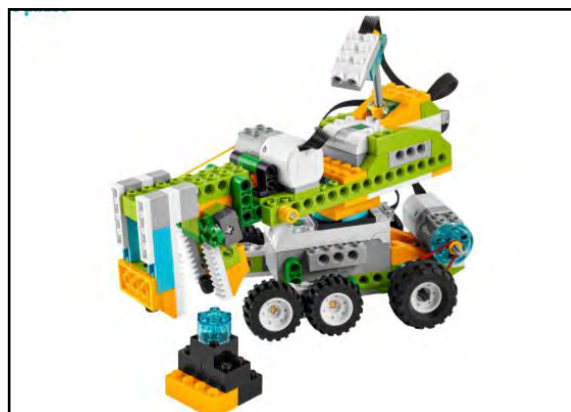
Εικόνα 21. Όχημα με 2 κινητήρες και 2 SmartHub
