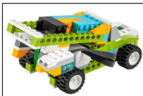
Εικόνα 19. Προσθήκη αισθητήρα στην κατασκευή
