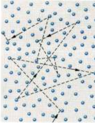
Εικ. 1.1 Ένα μόριο αερίου κινείται στο χώρο που καταλαμβάνει το αέριο, συγκρουόμενο με άλλα μόρια κατά τη διαδρομή του. Αν και στην εικόνα φαίνονται στατικά, τα άλλα μόρια κινούνται επίσης μ' έναν ανάλογο τρόπο.
