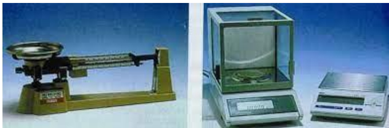
ΣΧΗΜΑ 1.3 Εργαστηριακός ζυγός ενός δίσκου με βερνιέρο και σύγχρονοι ηλεκτρονικοί ζυγοί ακριβείας για τη μέτρηση μάζας. 3
