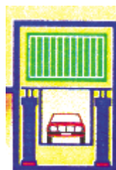
Σχέδιο 5.15 Χρησιμοποίηση άμεσης ανάρτησης με δύο έμβολα
